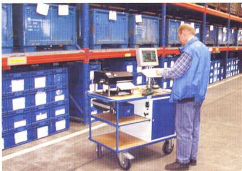
Mobile Arbeitsstation mit Etikettendrucker, Scan-Pistole und Industrie-PC mit Datenfunkanbindung an das Lagerverwaltungssystem. Schreib- und Ablageflächen sowie Verwahrmöglichkeiten machen die Arbeitsstation zum mobilen Büro mitten im Lager
